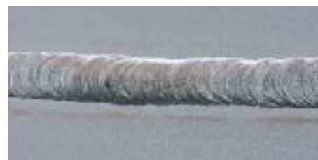
Formálógázzal kialakított gyökoldal, TIG hegesztéssel készült varrat
