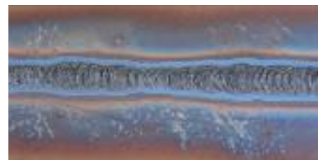
Formálógáz nélkül kialakított gyökoldal, TIG hegesztéssel készült varrat
