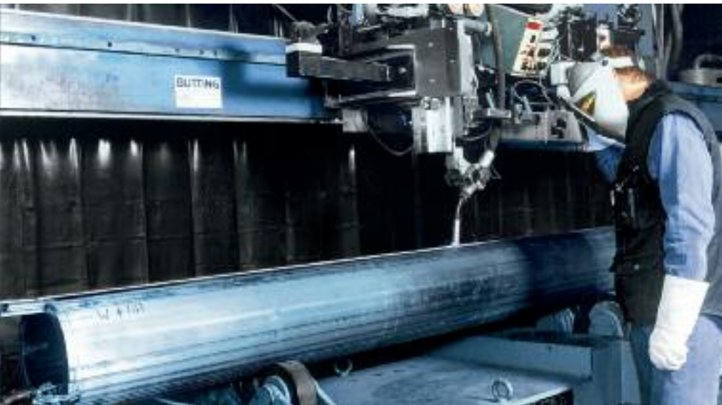
Speciális cső készítése hőkezelő kemencéhez Nicrofer® 6025HT alapanyagból 602CA hegesztőanyaggal Cronigon® Ni30 védőgázzal. (Forrás: H.Butting GmbH)
