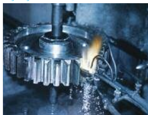
Különleges égő vízhűtéses lángedzéshez
