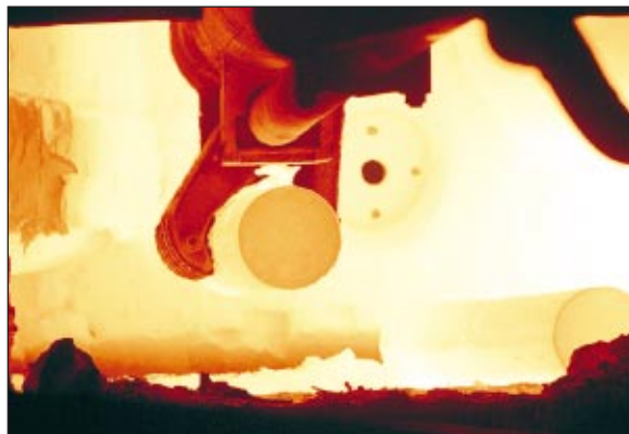
■ 21. ábra. Alacsony hőmérsékletű oxyfuel égő üzem közben
