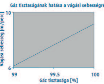
8. ábra: Gáz tisztaságának hatása a vágósebességre gázlézerek esetén. [7]
