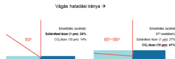
3. ábra: A lézertípus és a felületi normális által bezárt szög a lemez vastagságának függvényében, illetve ezekhez a beesési szögekhez tartozó lézertípus elnyelődési százalék 1 µm és 10 µm hullámhosszú lézertípus esetén. [4]
