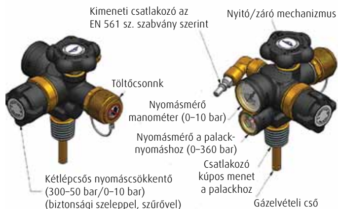
10. ábra. A ViPR szelep fő elemei a kétfokozatú nyomáscsökkentővel védőburkolat nélkül
