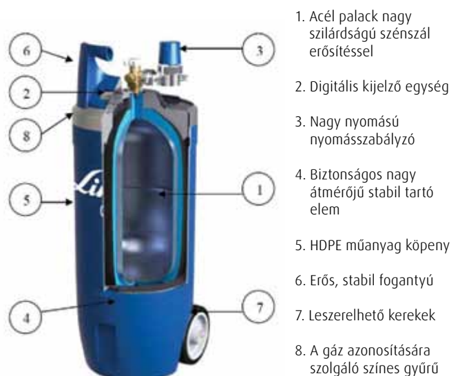
11. ábra. A kompozit palack felépítése
