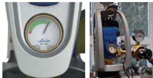
7. ábra. A szelepbe épített töltöttségjelző, egy manométeres nyomáscsökkentő alkalmazása
