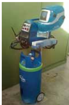
14. ábra. Hegesztési bemutatókhoz készített hordozható mobil állvány, kerekkel felszerelt GENIE® palackkal
