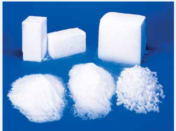
A szárzjég gyártási, szállítási formái (felső sor: különböző méretű blokkjég, alsó sor balról: szárzjég hó, pellet, nugget)
