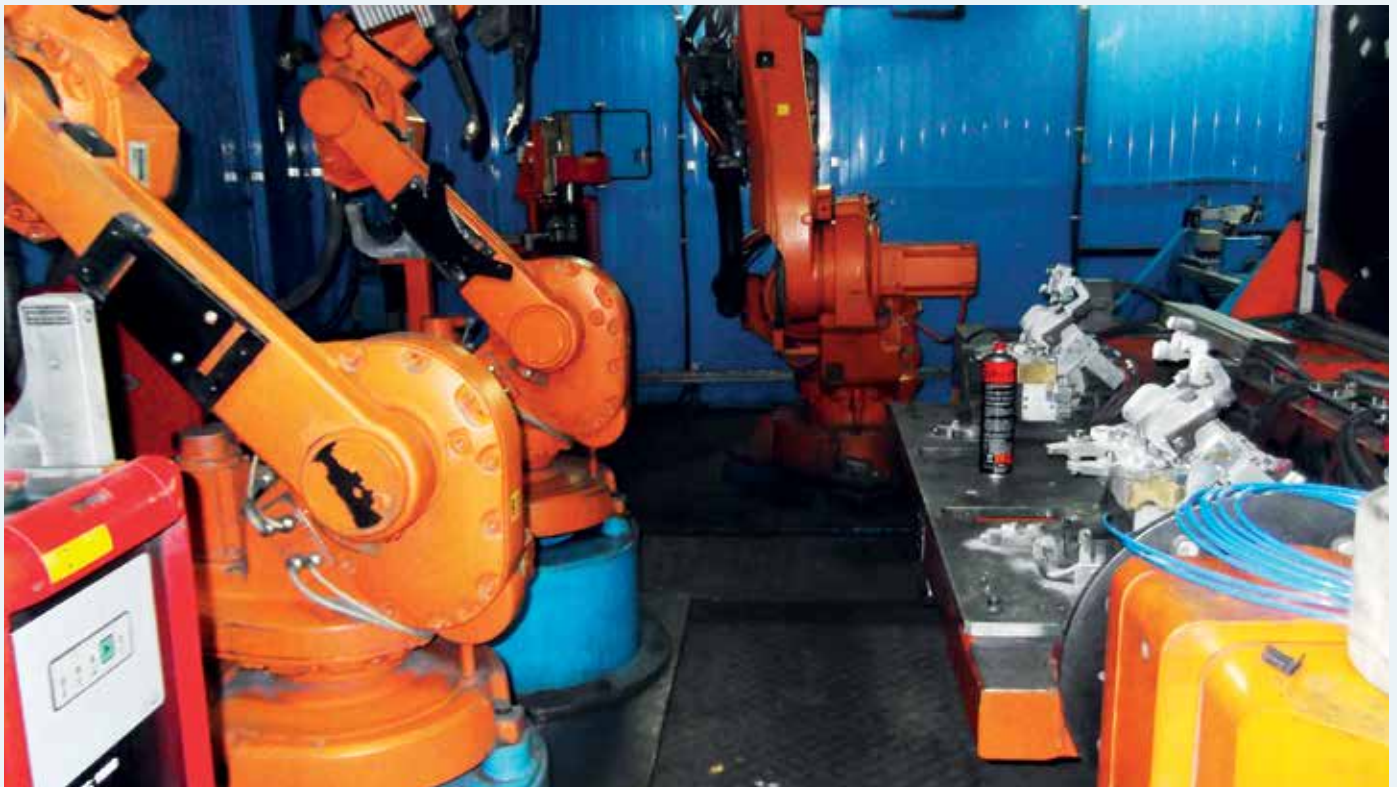
Hegesztőkészülék szárাজeges tisztítása a Gestamp Hungária Kft-nél
