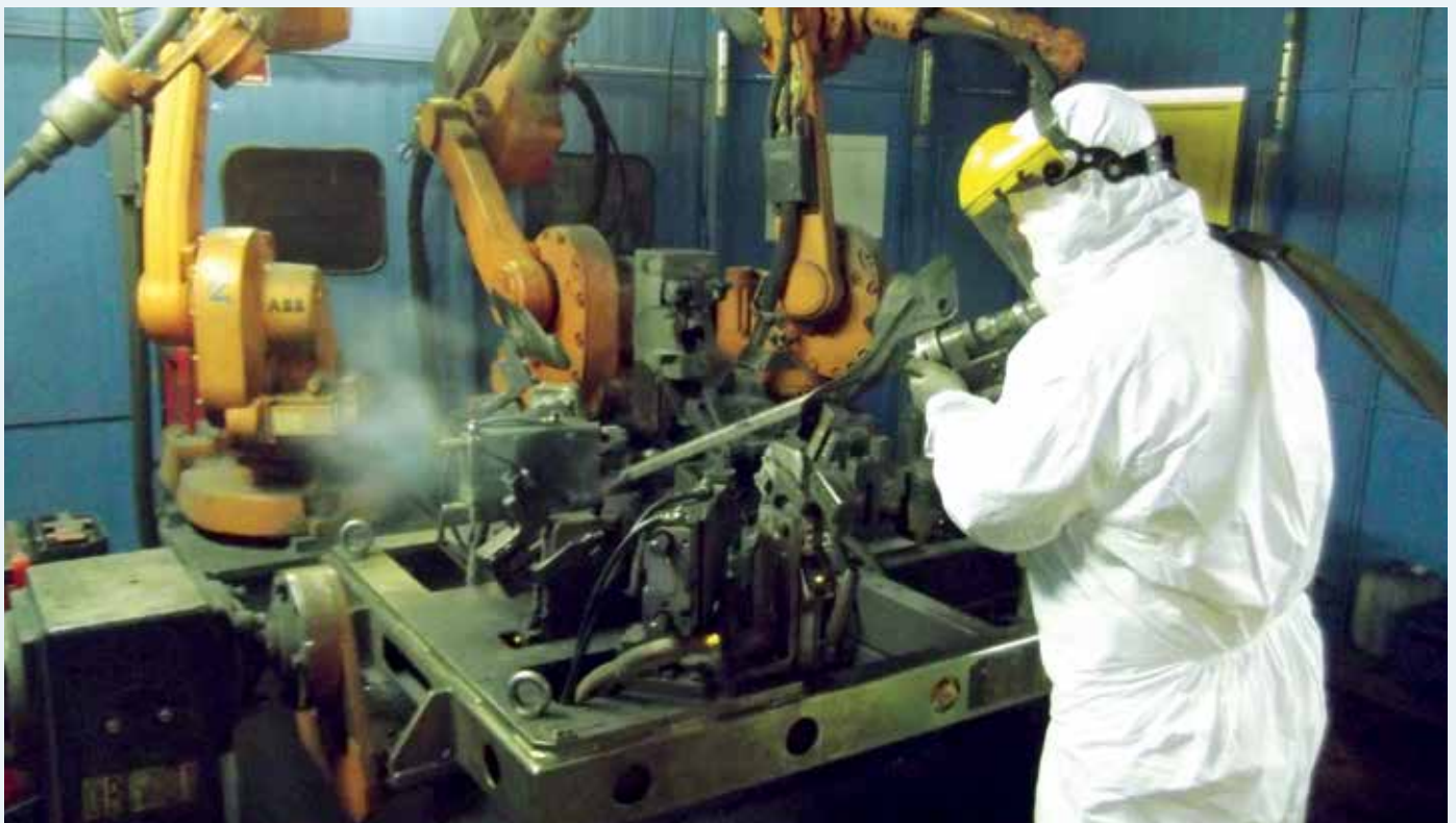
Hegesztőkészülék szárzjeges tisztítása a Gestamp Hungária Kft-nél
